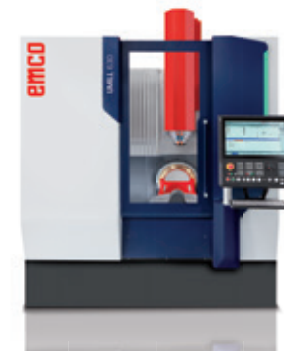
Centro di lavoro universale UMILL 630 per la lavorazione simultanea a 5 assi
