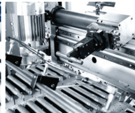
Taktförderband mit Prismenauflagen für unterschiedlich vorgeformte Wellenteile.
